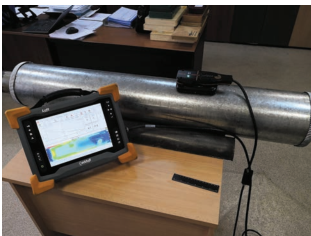
Рис. 13. Специализированный импульсный вихретоковый преобразователь EDDYFI
