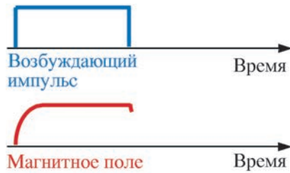
Рис. 3. Фаза отключения магнитного поля
