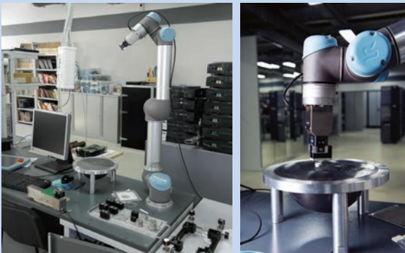
Роботизированный комплекс для паспортизации преобразователей
