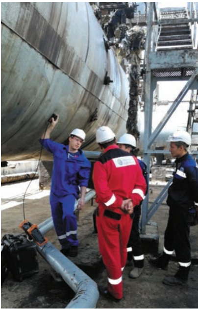
Рис. 6. Полевые испытания технологии PEC на НПЗ
